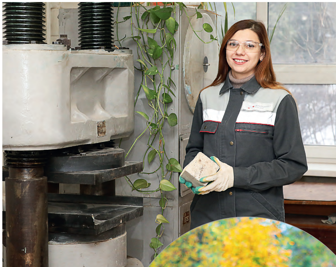
▲ Очередная проба бетона проверку на прочность прошла успешно
