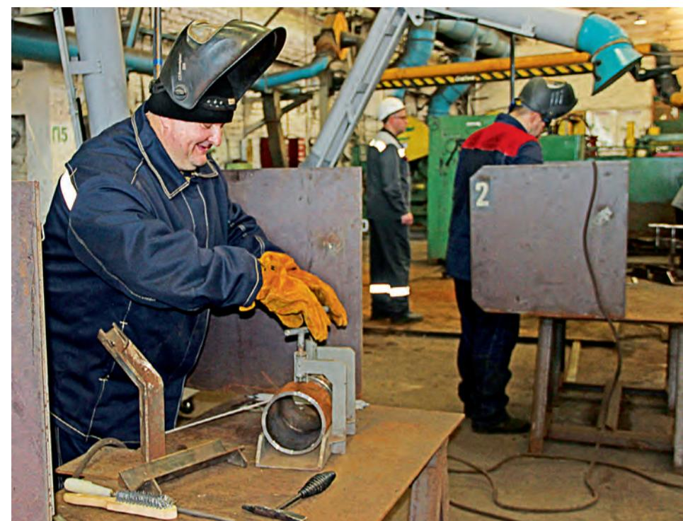
▲ Сварка двух труб под наклоном в 45 градусов позволяет получить полное представление об умении сварщика
