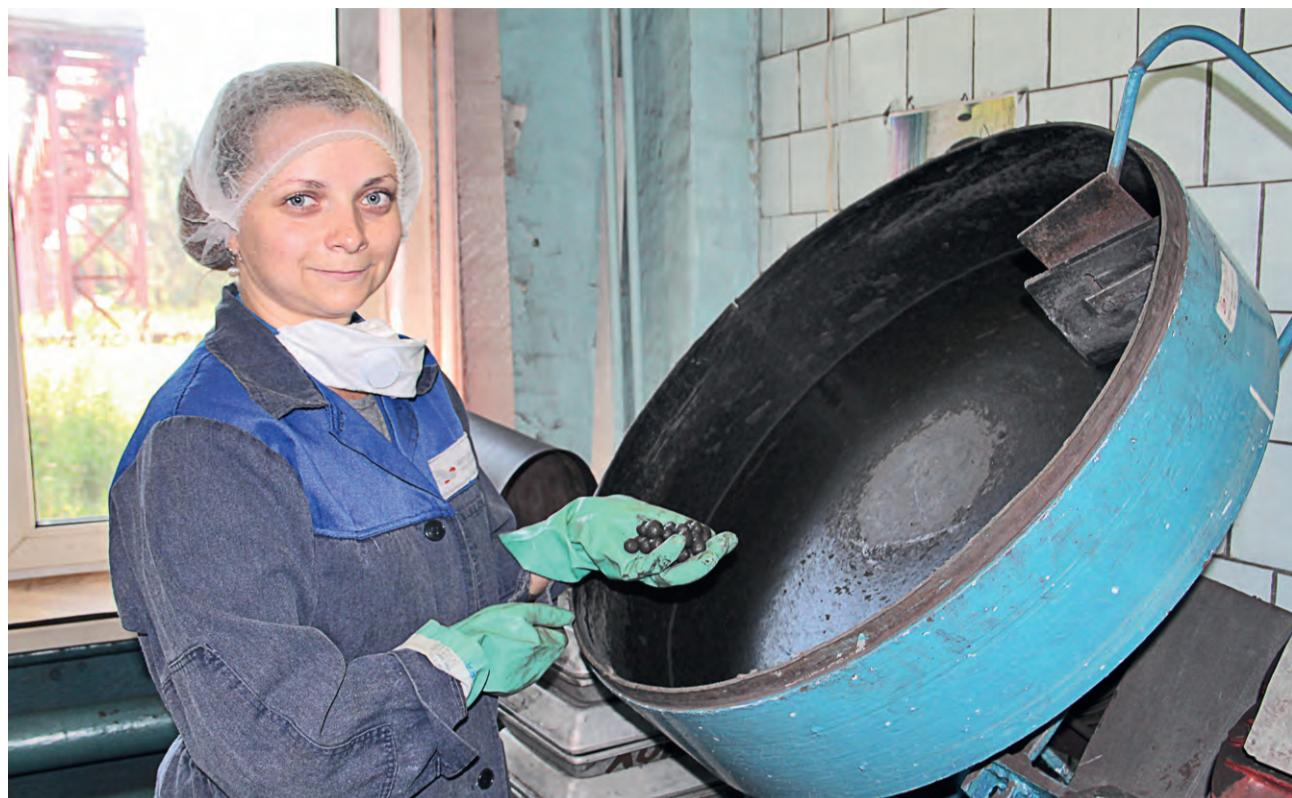
▲ Лаборант по физико-техническим испытаниям УТК МГОКа Анна Афанасьева вместе с коллегами несколько месяцев отрабатывала методику накатки, меняя дозировки известняка и бетонита, проверяя полученные сырье окатыши на содержание влаги, прочность на раздавливание и сброс.
