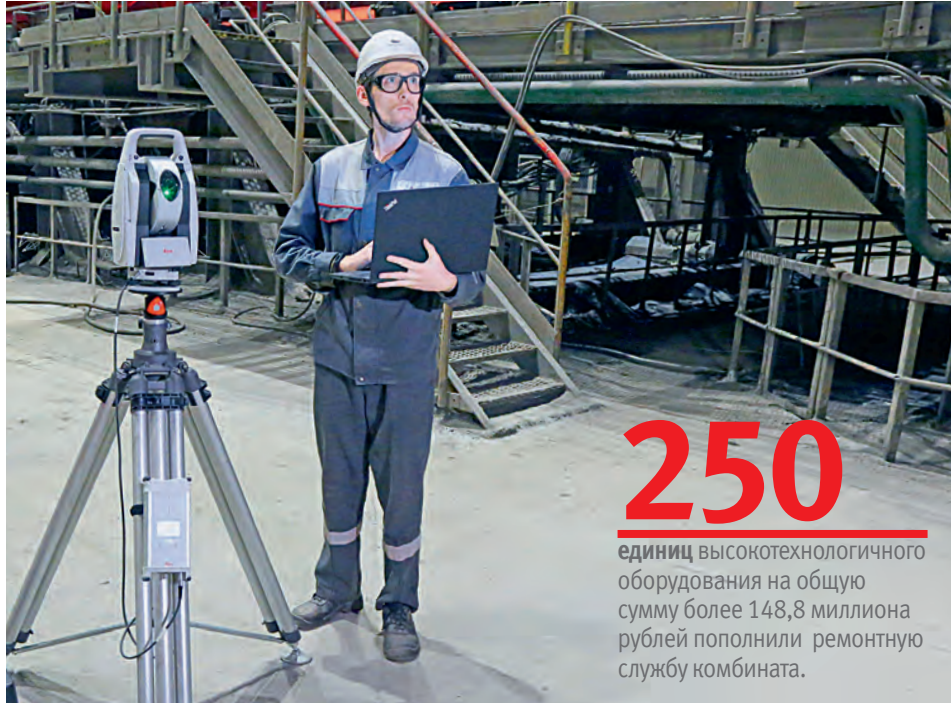
▲ Система лазерной центровки для выставления геометрических параметров оборудования
