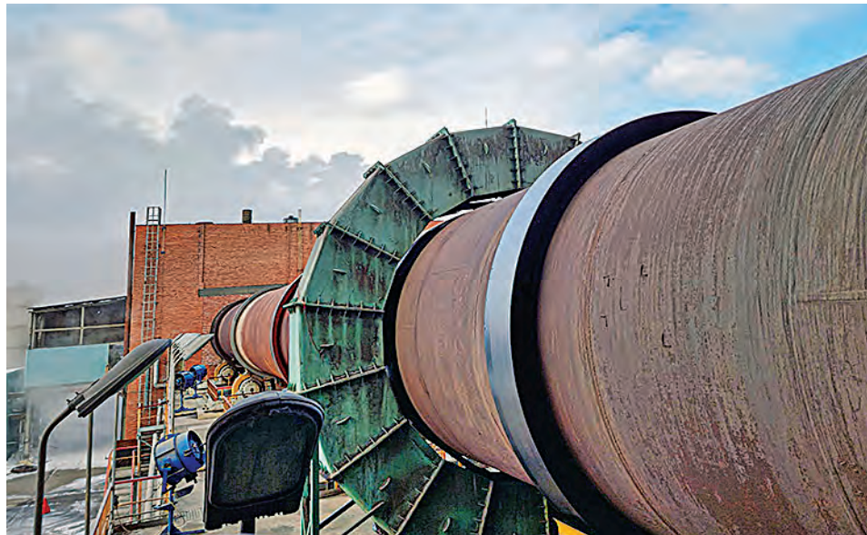
▲ Так выглядит печь для производства вельц-оксида цинка
