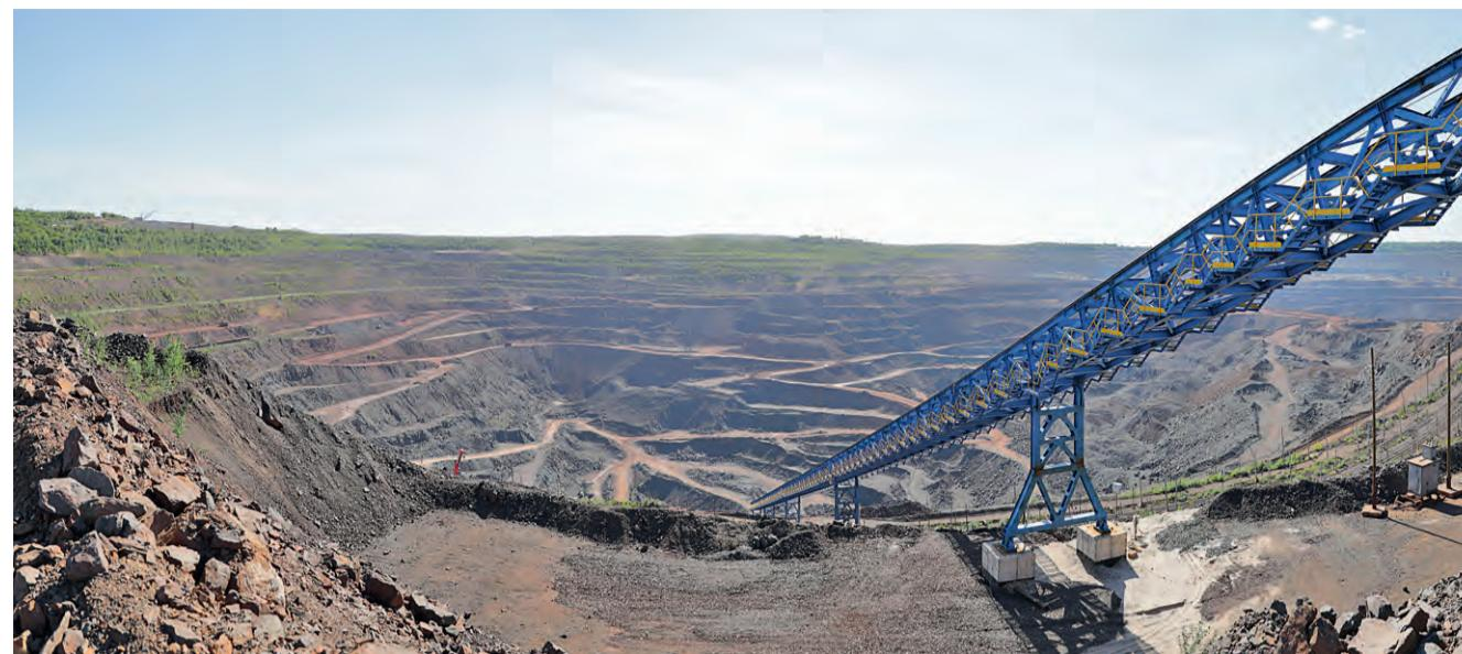
По размерам и конфигурации крутонаклонный конвейер ДКК станет уникальным в России: его угол наклона составляет 37 градусов, высота подъёма — 215 метров.
