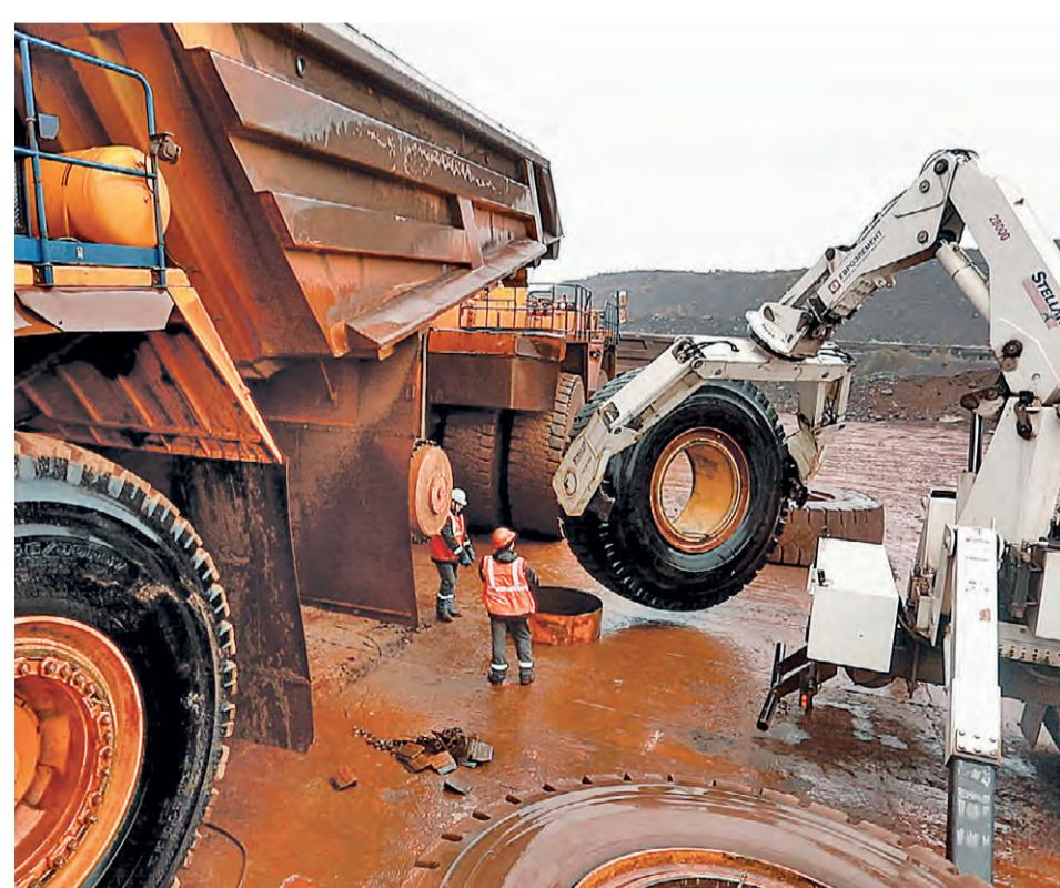
Процесс замены шин у БелАЗа впечатляет. Каждое из шести колёс весом почти пять тонн сначала снимают, потом переобуют и ставят на место. Чтобы эта работа прошла гладко, на помощь приходят ещё один БелАЗ, который выполняет роль многотонного домкрата, и робот-манипулятор.
