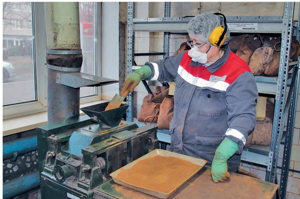
подсчётов. С помощью специального оборудования они определяют точные характеристики компонентов окатышей, их химический состав, содержание влаги и прочность.
