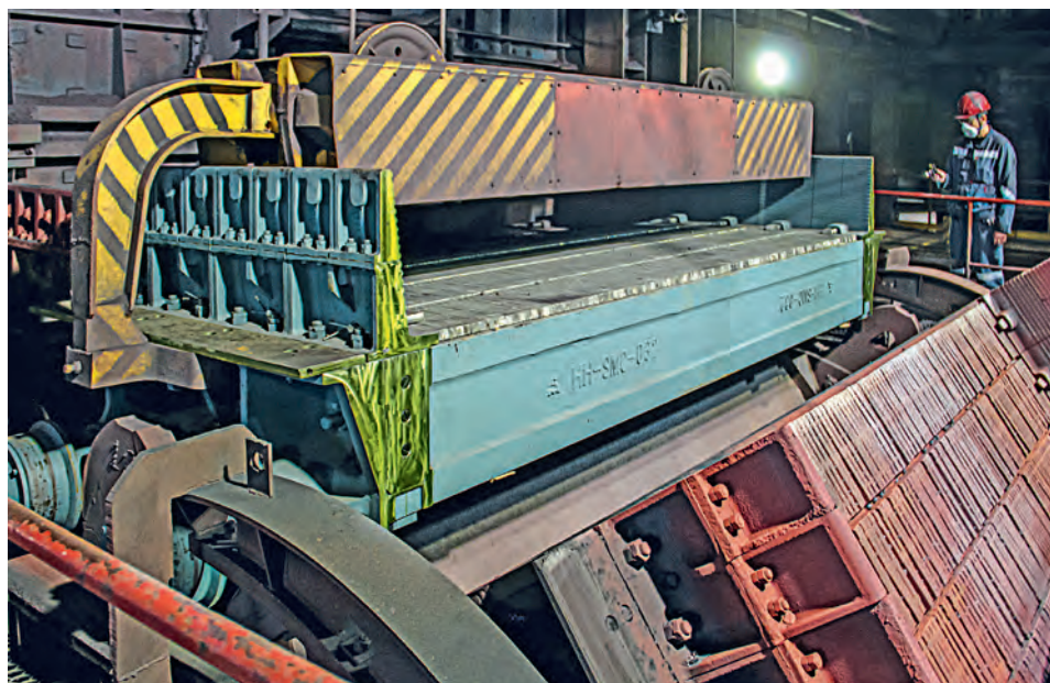
▲ В ходе ремонта на ОМ-1 заменили 12 рельсовых путей для обжиговых тележек
