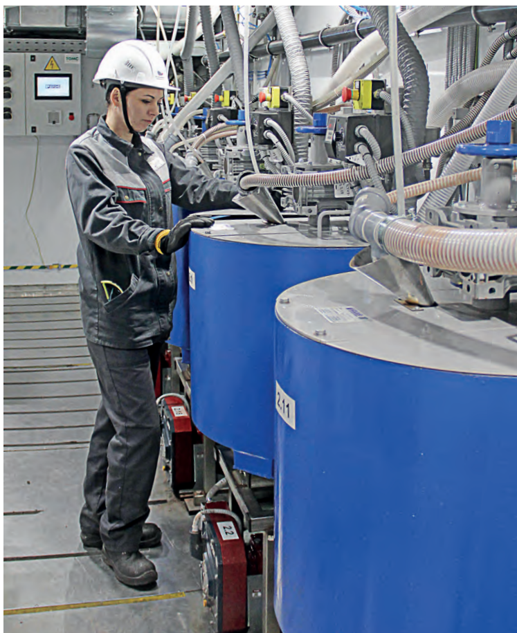
▲ Миниатюрные технологические линии опытно-промышленной установки детально воспроизводят все процессы обогащения
