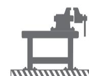
1. Верстаки, стеллажи, столы, шкафы, тумбочки должны быть прочными и надёжно установленными на полу.
