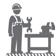
2. Тиски на верстаках должны быть установлены на расстоянии не менее 1 м один от другого и закреплены так, чтобы их губки находились на уровне локтя работающего.
