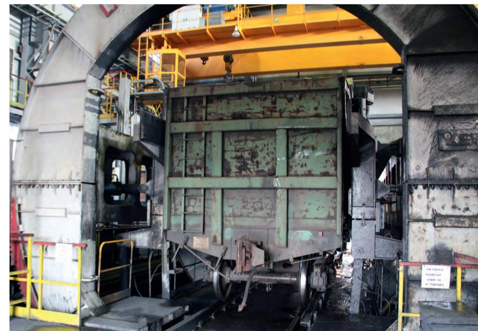
◀ Привалочная стенка вагоноопрокидывателя необходима для фиксации вагона на роторе и удержания его во время переворота
