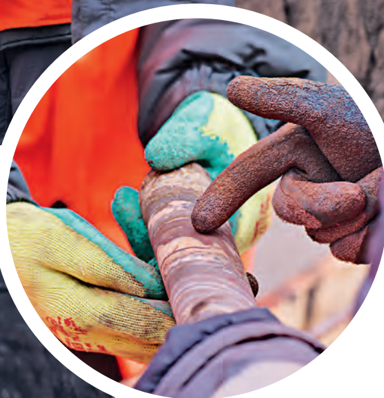
▲ Керн может «рассказать» геологам о том, на какой глубине находится руда, окисленные и неокисленные железистые кварциты
