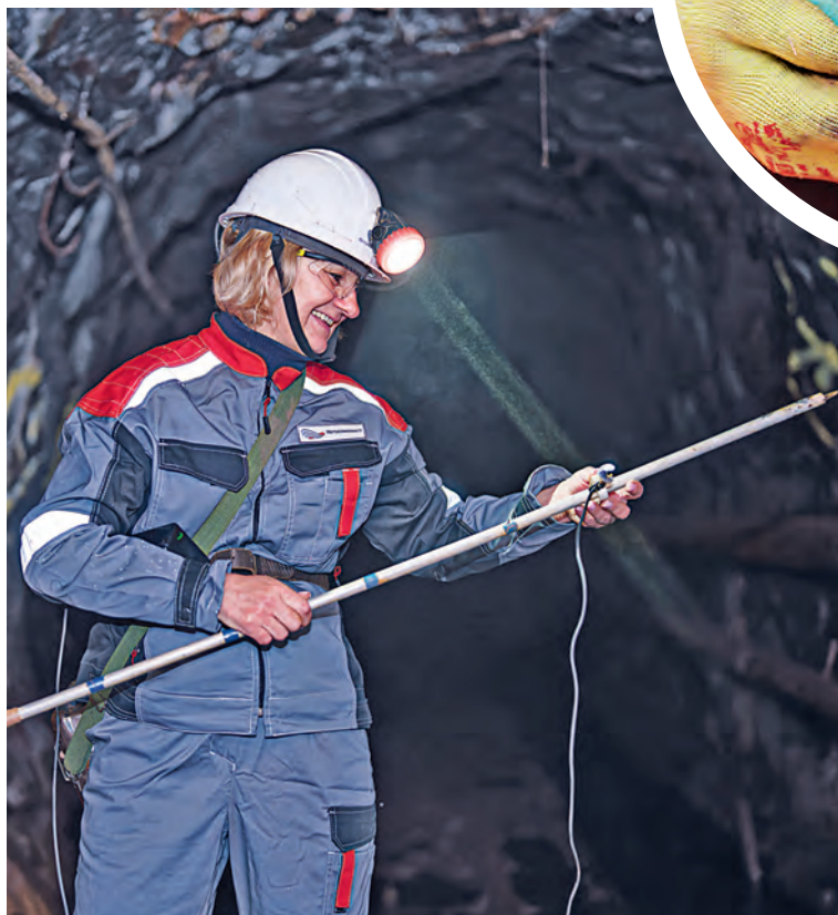
▲ Ведущий гидрогеолог дренажной шахты Светлана Шевченко отбирает пробы воды и проводит замеры. На основе полученных данных планируют бурение водопонижающих скважин
