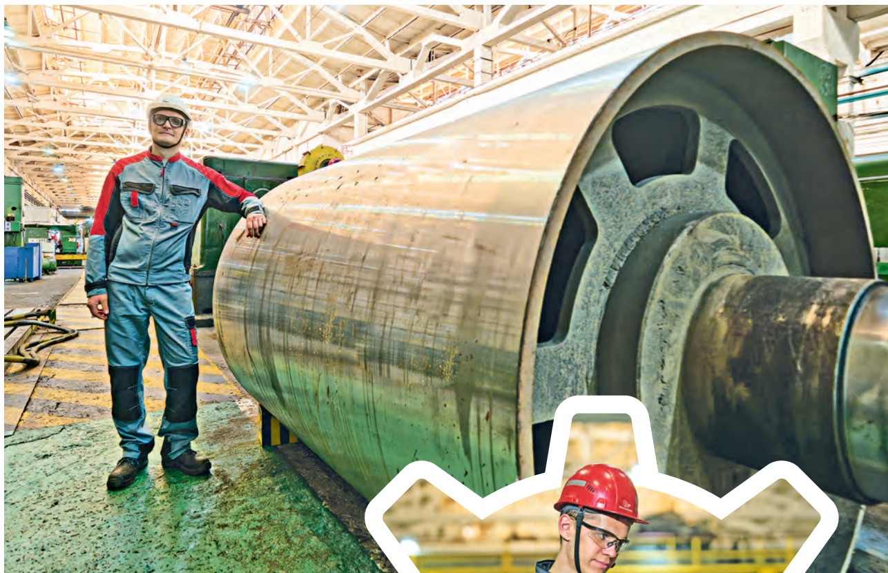
▲ Обводной барабан для дробильно-конвейерного комплекса весит более 12 тонн
