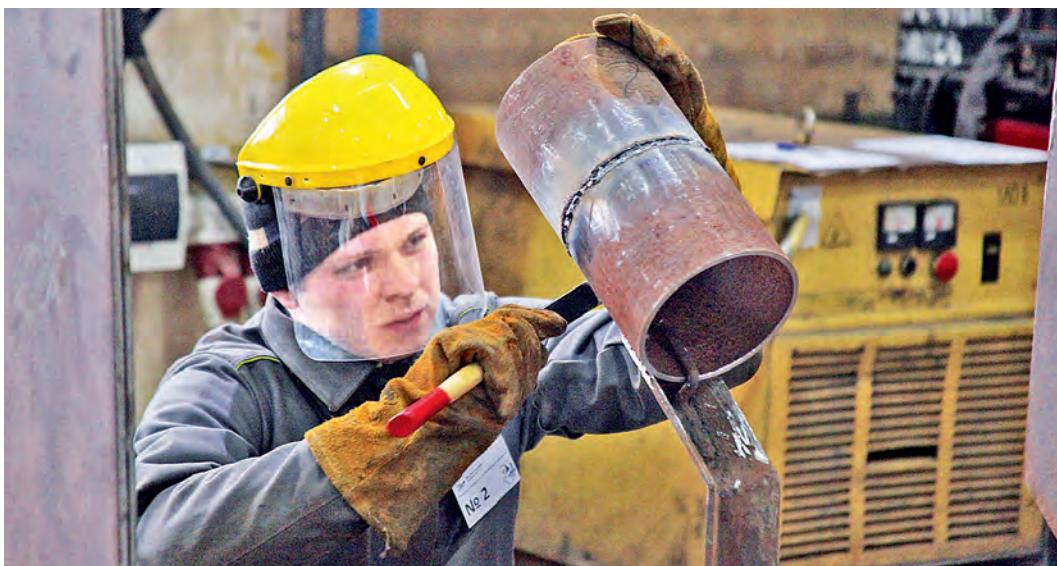
Чтобы сварной шов получился качественным, нужно точно совместить детали: без перекосов и зазоров.
