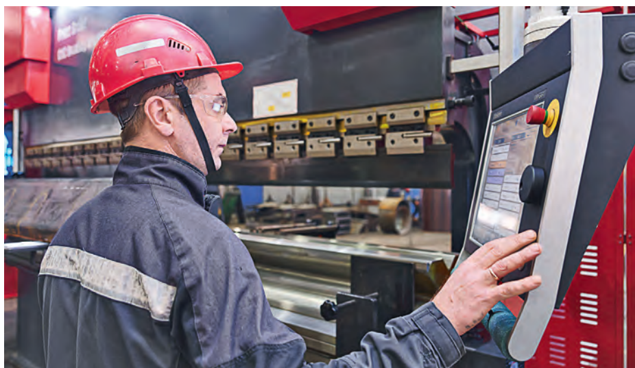
▲ Числовое программное управление станка позволяет оператору задавать любые параметры будущей детали
