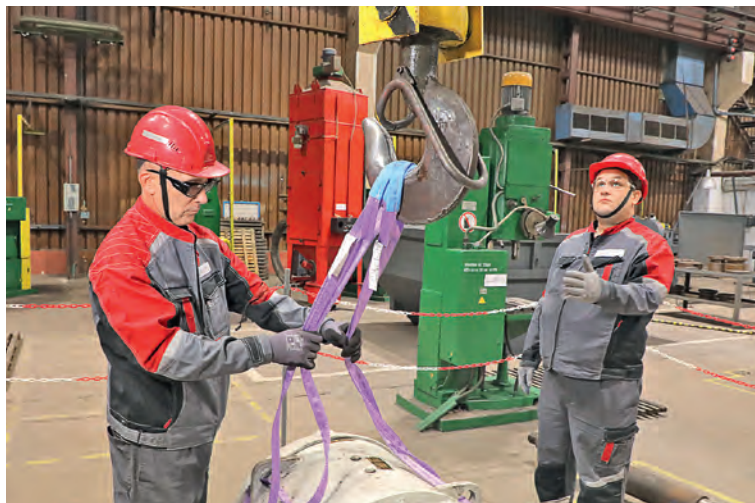
▲ Специалисты по ремонту электрооборудования ведут строповку электродвигателя на полигоне ОЭМК
