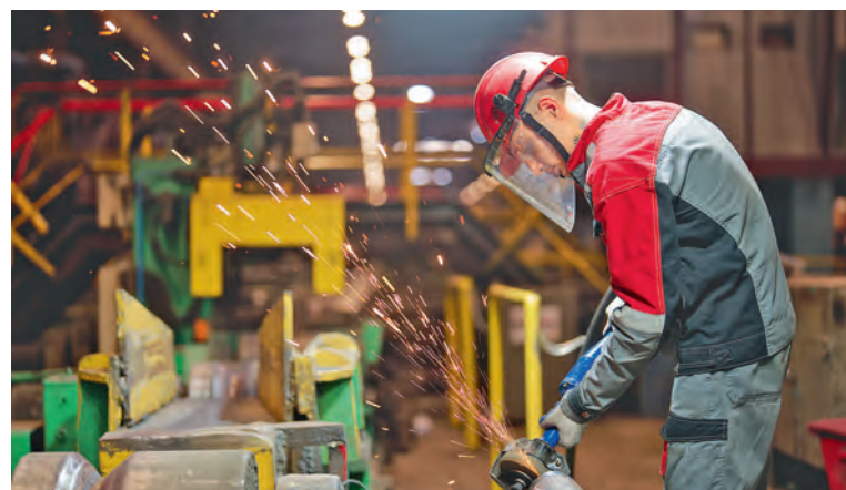
▲ Оператор поста управления СПЦ № 1 ОЭМК Артём Папян проводит зачистку торцов металлопроката
