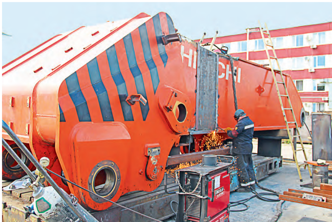
▲ Сварочные работы при ремонте стрелы требуют особого мастерства, ведь каждый шов должен полностью соответствовать ГОСТам
