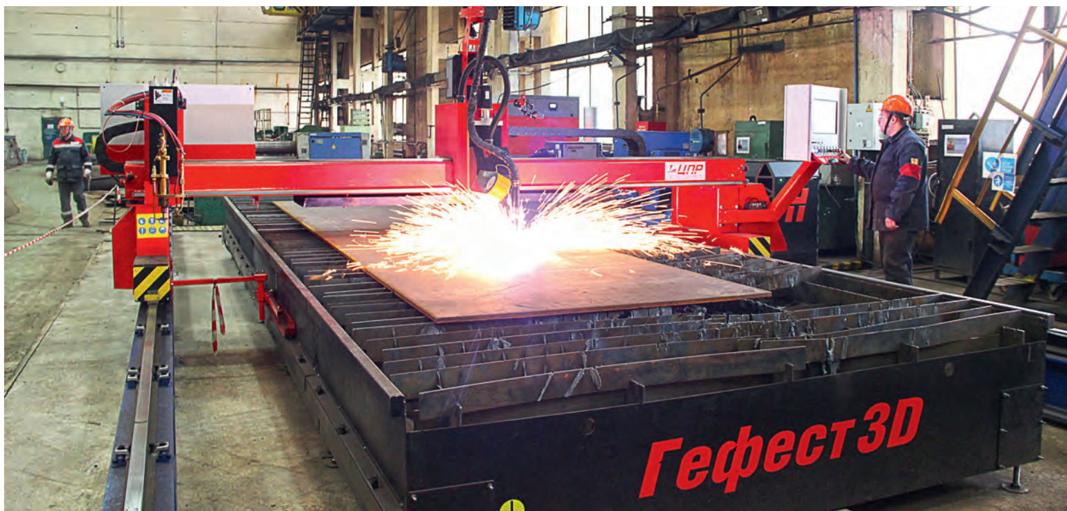
▲ Около 30 тысяч градусов достигает температура плазмы, при помощи которой «Гефест» режет металл
