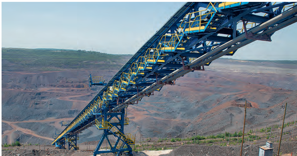
▲ 700-метровый крутонаклонный конвейер способен перемещать свыше 72 тысяч тонн горной массы в сутки с нижних горизонтов на самый верх
