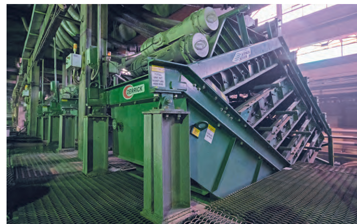
▲ Внедрение технологии тонкого грохочения — важнейший элемент комплексной программы повышения качества железорудной продукции Михайловского ГОКа
