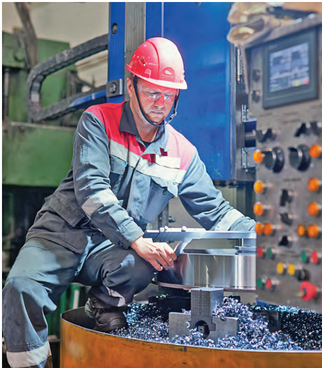
▲ Специалисты МСЦ качественно выполняют поставленные задачи: вытачивают для фабрик комбината брони, детали насосов, мелкие запчасти на фабричное оборудование
