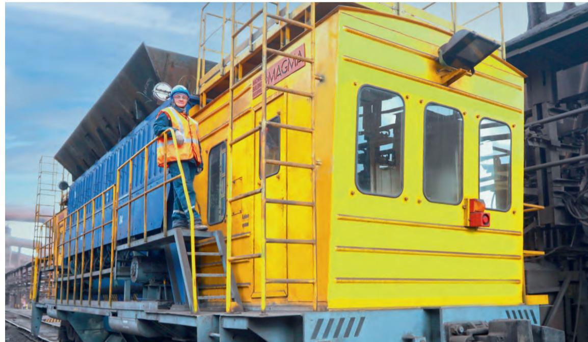
собой самоходный полувагон с приёмным бункером, грузоподъёмностью 70 тонн, с выгрузочными люками донного типа с обеих сторон, открывание и закрывание которых осуществляется с помощью электропривода. У машины две кабины, в каждой — идентичные пульты управления всеми механизмами трансферкара. Таким образом машинист всегда чётко контролирует обстановку перед движущимся составом.
