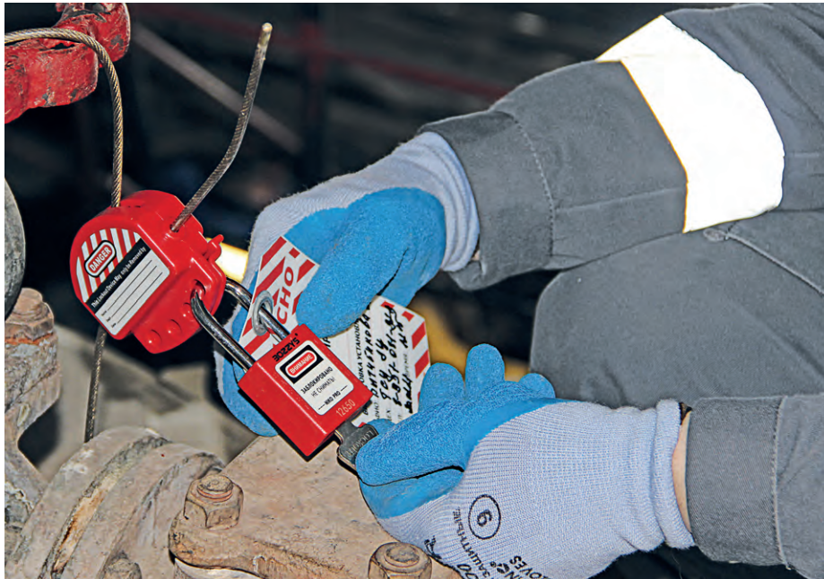
▲ Блокиратор надёжно «запирает» задвижку и никому не позволяет её открыть даже при сильном желании
