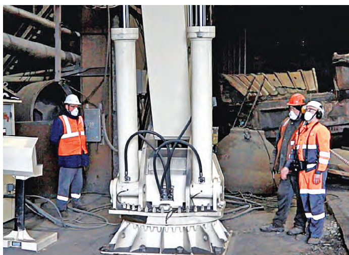
▲ Стрела гидромолота для разрушения негабаритных кусков породы
