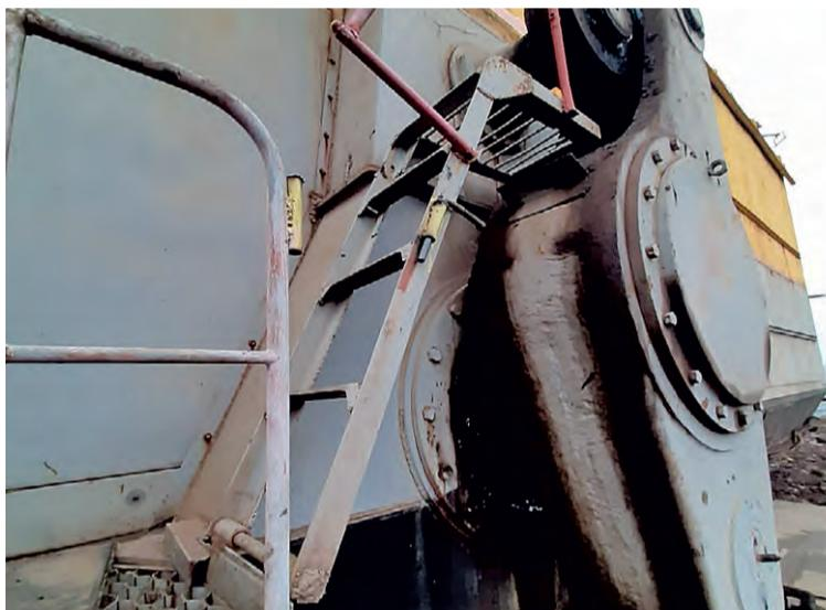
▲ Специальная площадка, оборудованная на шагающем экскаваторе по предложению машиниста-инструктора рудоуправления МГОКа Владимира Козырова, позволяет быстро и безопасно проводить ТО рычагов эксцентриков в зимний период
