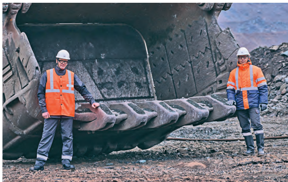
▲ Экскаваторщики рудоуправления предложили установить на ковш WK-35 такую же переднюю стенку под зуб, что используется на других экскаваторах, вместо оригинальной китайской
