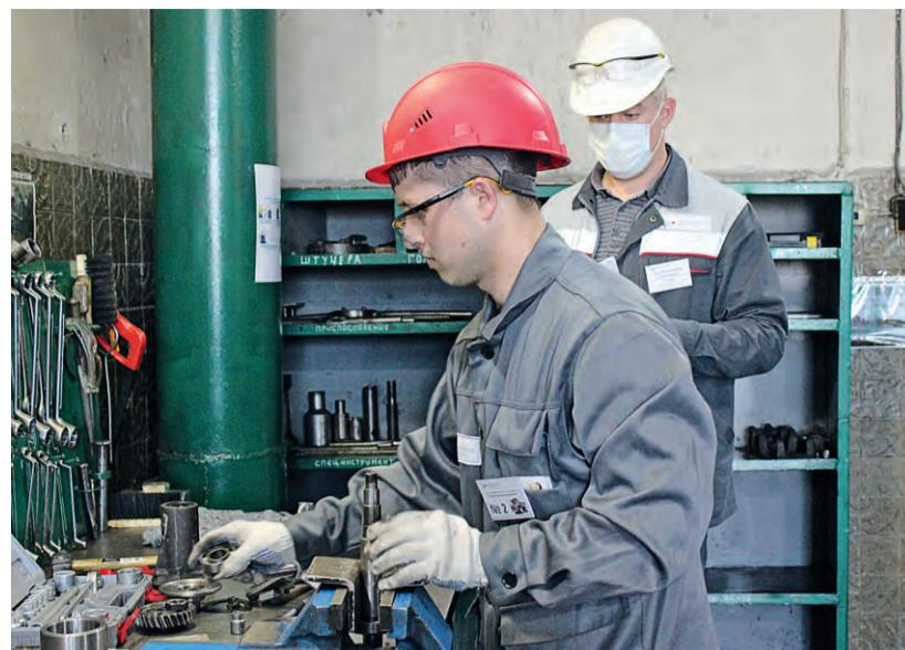
▲ Участникам конкурса нужно было разобрать привод генератора автомобиля БелАЗ-7548, определить износ деталей и проверить ведущий вал, промерив его микрометром
