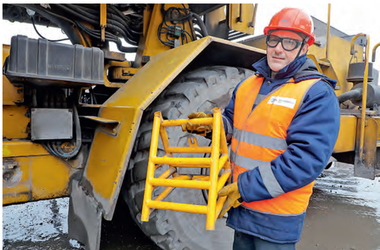
▲ ОЭМК. Водители уже оценили облегченные противоткатные упоры. Ими теперь обеспечены все транспортные средства
