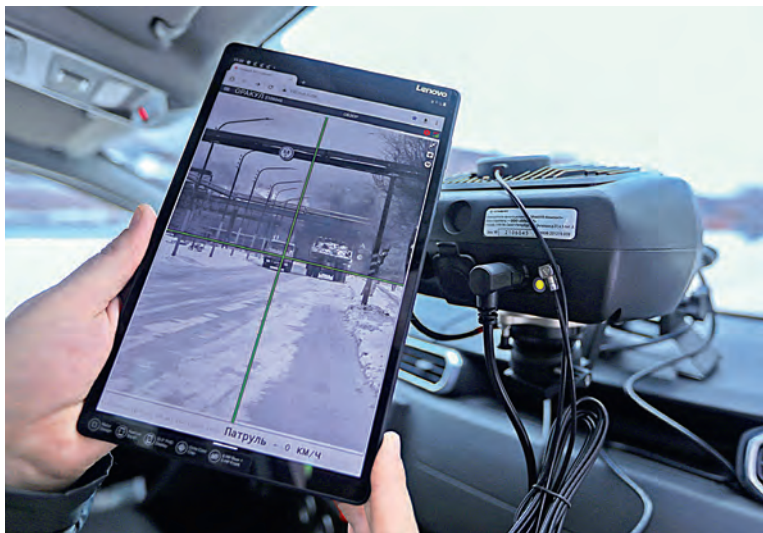
▲ Уральская Сталь. Новый мобильный комплекс фиксирует скорость движения транспортных средств, выезд на встречную полосу, опасное маневрирование и даже нарушения пешеходов
