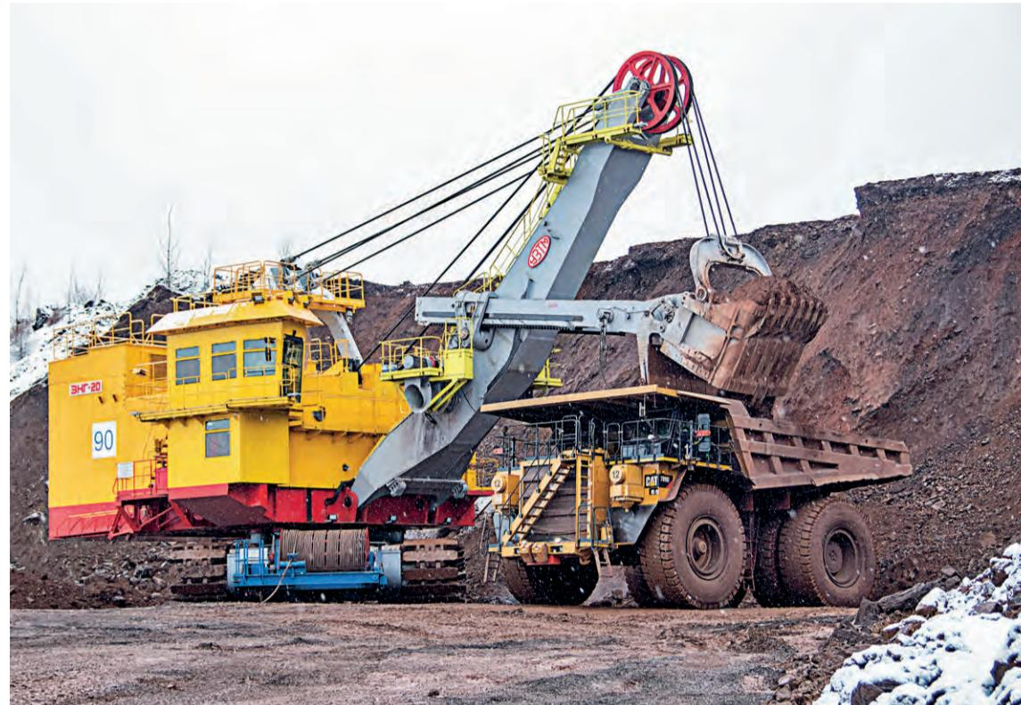
Чтобы заполнить кузов большегрузного самосвала, вместительному ковшу экскаватора достаточно зачерпнуть породу всего четыре раза
