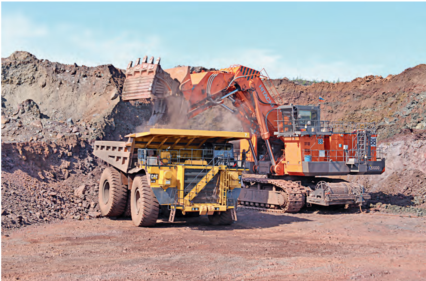
Сегодня в карьере работают 130, 160 и 180-тонные БелАЗы, «Катерпиллеры», экскаваторы с объёмом ковша 15, 18 и 23 куба.
