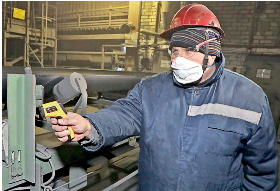
▲ С помощью тепловизоров работники контролируют температуру металлизированной пыли и окатышей
