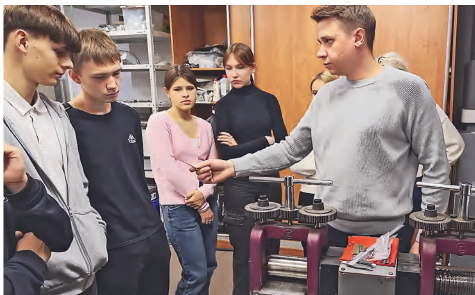
▲ Железнгорцы наблюдают за работой ювелирного вальца, который называют холодным прокатным станом в миниатюре
