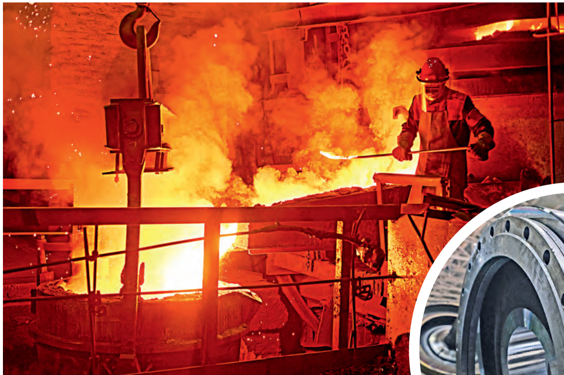
▲ В фасонно-литейном цехе из расплавленного металла рождаются прочные зубья для экскаваторов, мельничные брони и сотни других деталей
