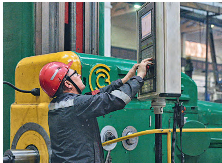
▲ Цифровая «начинка» станка позволяет существенно сэкономить время изготовления деталей: оператор задаёт нужные параметры, по которым станок самостоятельно обрабатывает изделие
