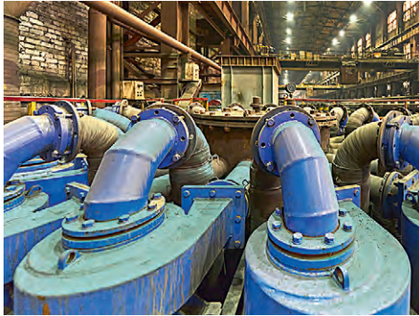
▲ Резиновую футеровку на керамическую заменили уже на 28 гидроциклонах
