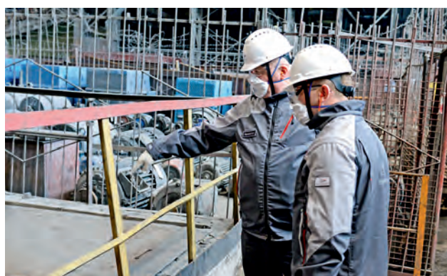
▲ Назим Эфендиев обратил внимание на плохо закреплённое ограждение — это потенциальный риск
