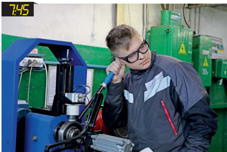
▲ 7:45. Приступаю к выполнению задач. Надо проверять подшипники электроприводов различного оборудования. Нам привозят и совсем новые, и те, что уже используются. Сначала визуально осматриваем: нет ли внешних дефектов? Измеряем геометрические параметры и сверяем их с ГОСТами. Затем при помощи специальных станков проверяем, есть ли шум и трудности при вращении этих деталей. Если отклонений нет, значит, подшипник годный. Дефектные отправляем на металлолом.
