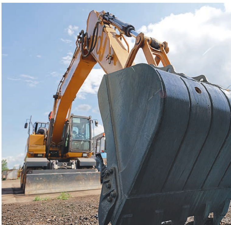
▲ Ёмкость ковша нового экскаватора — 0,9 кубических метра, но при необходимости он может взять «на борт» до 1,1 кубометра
