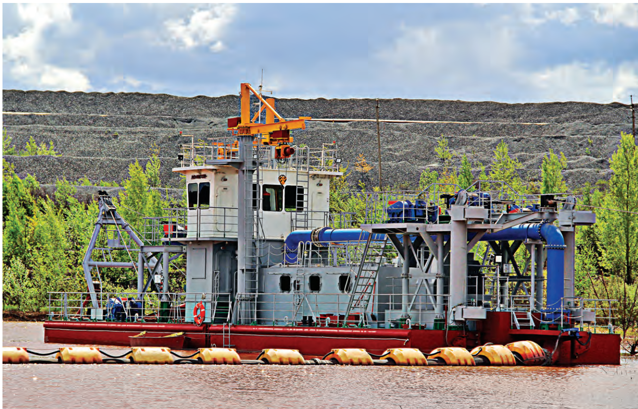
▲ Новый земснаряд — мощный и эффективный: производительность насоса — две тысячи кубометров в час
