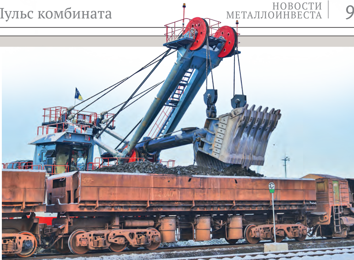
▲ Новый экскаватор грузит рудную массу, которая поступает на борт карьера по дробильно-конвейерному комплексу № 2
